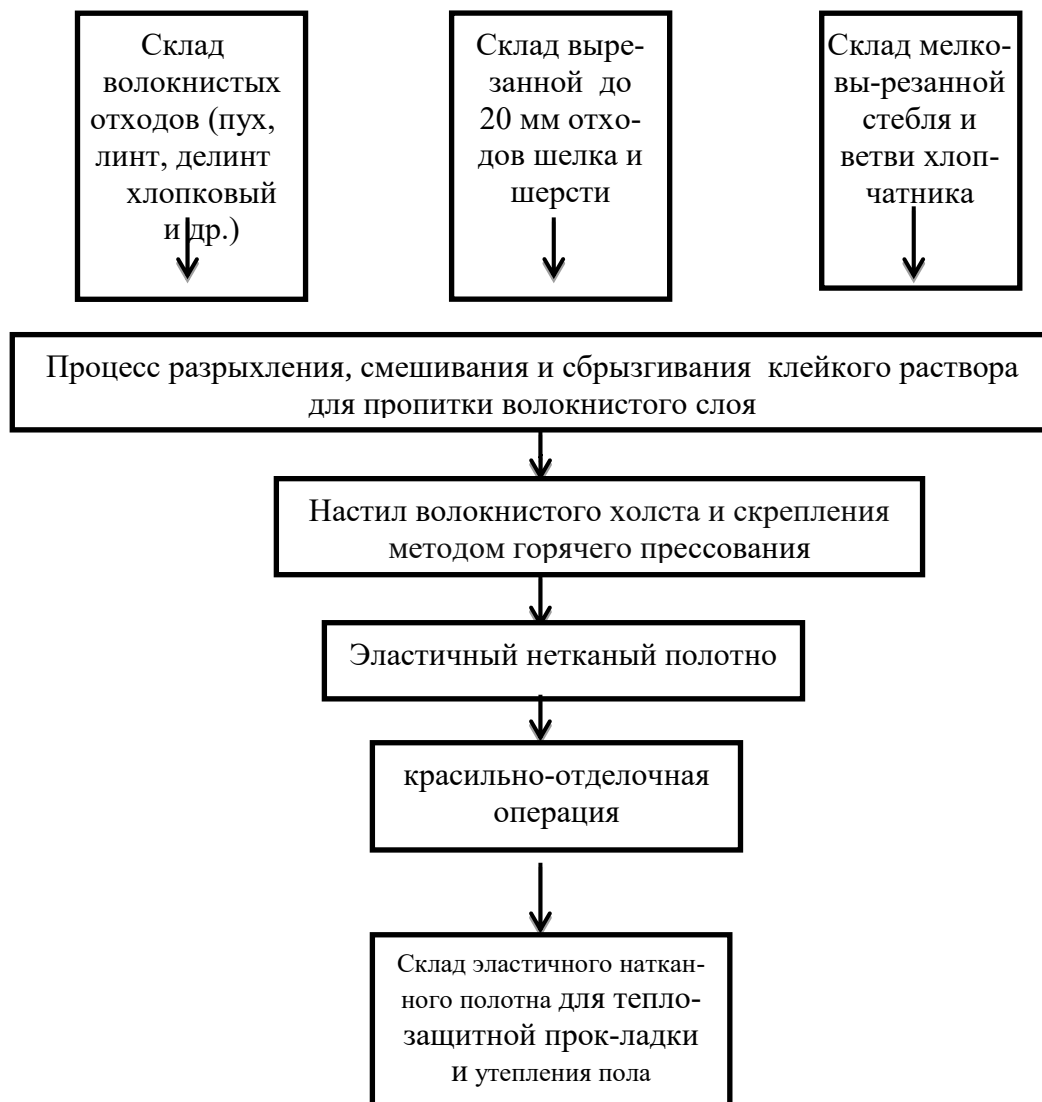
Фиг. 3. Линия хлопкозавода по производству эластичного нетканого полотна для теплозащитной прокладки и утепления пола
